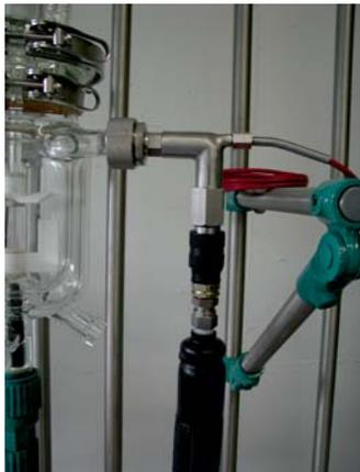
Der Anschluss des Schlauches erfolgt jeweils durch Edelstahl-Überwurfmutter mit Gewinde M16x1, M24x1.5, M30x1.5 od. M38x1.5 (andere Gewinde auf Anfrage).
